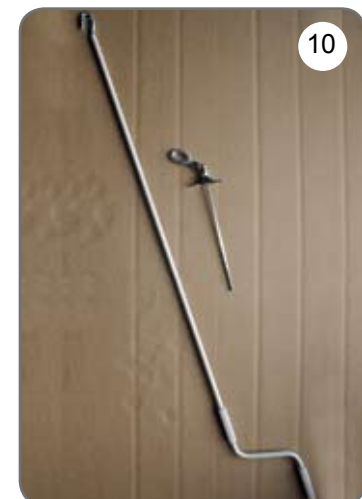
Korba, przegub Cardana 45° lub 90° z uchem [10].
