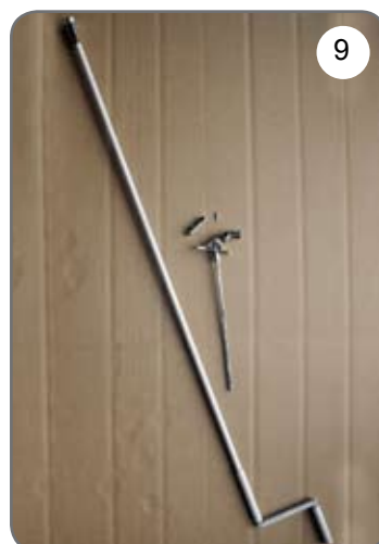
Korba, przegub Cardana 45° lub 90° z zaczepem dzwinkowym [9].
